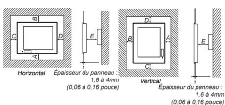
Laissez les espaces entre le GOT et les autres dispositifs en fonction des dimensions contenues dans le tableau suivant. Les valeurs entre parenthèses s'appliquent au cas où aucun dispositif générant des émissions sonores (comme un contacteur) ou de la chaleur n'est installé près du GOT. Toutefois, maintenez la température ambiante du GOT à 55°C ou moins. Unité: mm (pouce)
