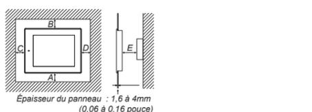
Laissez les espaces entre le GOT et les autres dispositifs en fonction des dimensions contenues dans le tableau suivant. Les valeurs entre parenthèses s'appliquent au cas où aucun dispositif générant des émissions sonores (comme un contacteur) ou de la chaleur n'est installé près du GOT. Toutefois, maintenez la température ambiante du GOT à 55°C ou moins.
